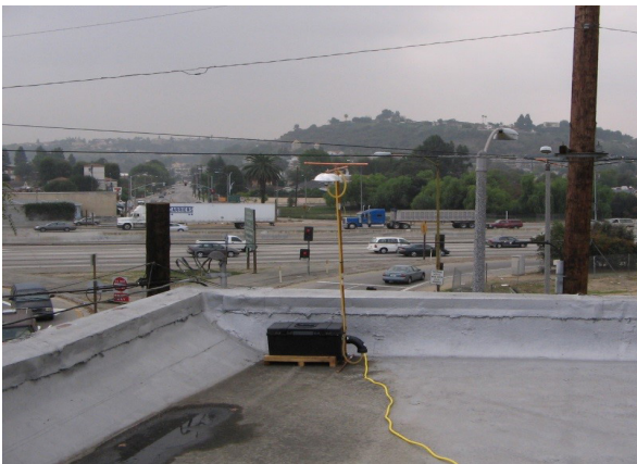
Esta foto muestra un monitor de MESA Air en el techo de una escuela primaria en Los Ángeles. Esta escuela está cerca de una autopista principal donde pasan muchos automóviles y camiones todos los días.
